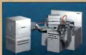
MAT 900XL-Trap — масс-спектрометр высокого разрешения, система МС-МС 10
